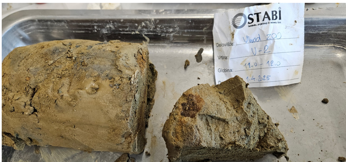
Slika 3: vzorec, ki je bil heterogen (V-2, 11.8-12.0m)
